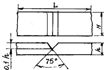
где  $h$  — толщина образца;  $H$  — ширина образца;  $L$  — длина образца
